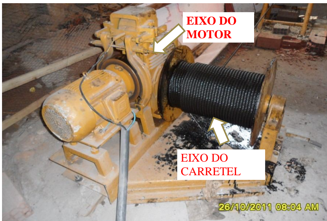
Figura 9 – Guincho automático eletromecânico Fonte: Arquivo pessoal (2011)
