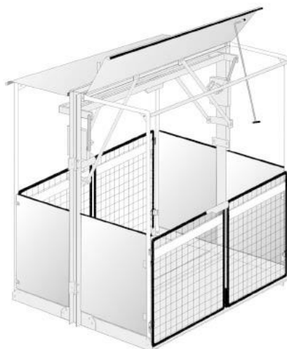
Figura 28 – Cabine semi-fechada – elevador de materiais Fonte: Brasil (2001)
