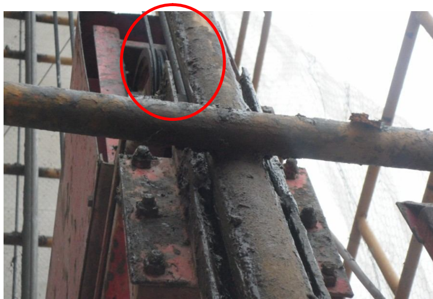
Figura 1 - Estrutura lateral da torre do elevador – bronzina engraxada. Fonte: Arquivo pessoal (2011)
