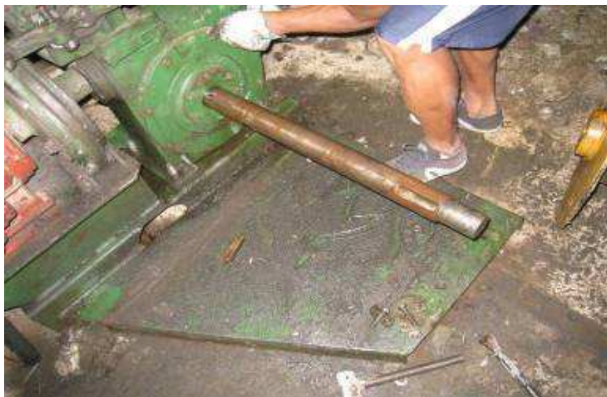
Figura 11 – Eixo acoplado à coroa dentada onde é instalado o carretel. Fonte: Arquivo pessoal (2011)
