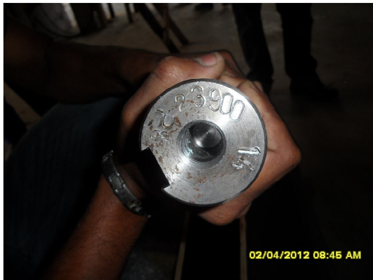
Figura 21 - Eixo identificado com gravação em baixo relevo. Fonte: Arquivo pessoal (2012)
