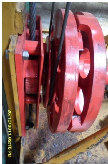
Figura 37 – Freio de emergência excêntrico Fonte: Arquivo Pessoal (2011)
