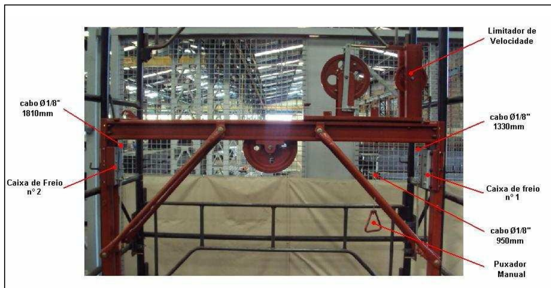
Figura 35 – Sistema geral freio cunha Fonte: Arquivo Pessoal (2011)
