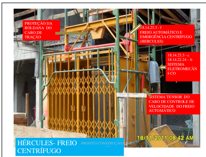
Figura 38 – Freio de emergência excêntrico Fonte: Arquivo Pessoal (2011)
