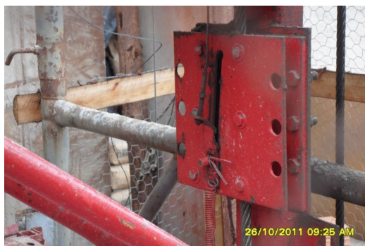
Figura 36 – Fotos caixa de freio cunha em detalhe Fonte: Arquivo Pessoal (2011)
